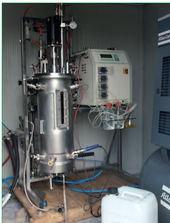
Figura 3 - Impianto pilota di fermentazione per la produzione delle biomasse delle colture starter.
